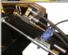
Regolazione di taglio elettro-idraulica Réglage de la hauteur de coupe electro-hydraulique Electro-hydraulic cutting height adjustment Elektro-hydraulische Einstellung der Schnitthöhe regulación electro-hidráulica de la altura del corte
