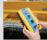
Comandi elettro-idraulici con joystick Commandes electro-hydrauliques avec joystick Electro-hydraulic control with joystick Elektro-hydraulische Steuerung mit Joystick Mandos electro-hidráulicos con joystick
