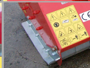
Slitte laterali regolabili Patins laterales réglables Adjustable side skids Verstellbare seitliche Kufen Patines laterales regulables
