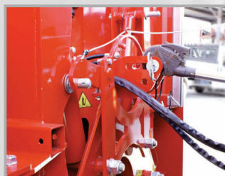
Sicurezza meccanica per trasporto su strada Sécurité mécanique pour transport sur route Mechanical safety for road transport Mechanische Sicherheit für Straßentransport Protección de seguridad para el transporte por carretera
