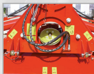
Attacco terzo punto cat. 2 o 3 Attelage catégorie 2 ou 3 Three point linkage 2nd or 3rd cat. Dreipunktboch Kategorie 2 oder 3 Enganche de 3 puntos IIª o IIIª cat.
