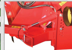
Regolazione idraulica dell'altezza di taglio Réglage hydraulique de la hauteur de coupe Hydraulic cutting height adjustment Hydraulische Einstellung der Schnitthöhe Regulación hidráulica de la altura del corte
