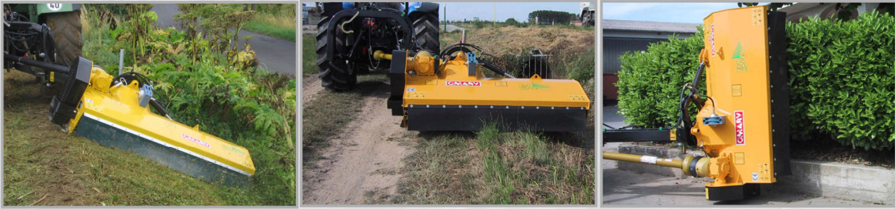
Versione con gruppo interno Version avec boîtier à l'intérieur Version with internal gearbox Version mit inneren Getriebe Versión con grupo de transmisión normal
