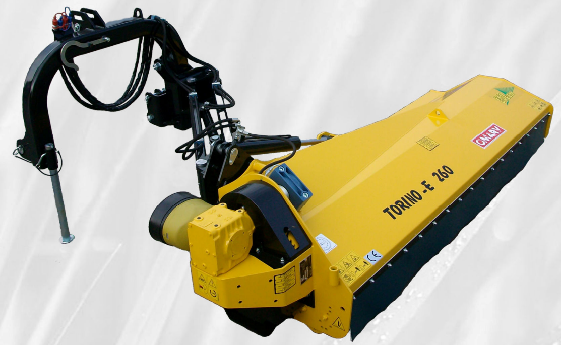
Versione con gruppo esterno Version avec boîtier à l'extérieur Version with external gearbox Version mit aussenliegenden Getriebe Versión con grupo de transmisión exterior
