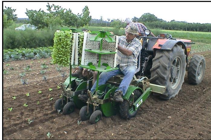
TRAPIANTATRICE SEMIAUTOMATICA A BICCHIERI DIISTRIBUTORI PERFORATORI; per piantine con zolla conica, troncoconica, piramidale, tronco-piramidale fino a cm 7 e cubica fino a cm 6x6. E' dotata di bicchieri perforatori per diversi tipi di zolle. La distanza tra piantine è regolabile da cm 15 a cm 162 anche in rapporto al numero di bicchieri. Lavora anche su film plastici. Capacità di trapianto circa 3000 piante/ora per ogni elemento.
