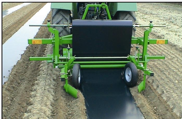
**PACCIAMATRICE** – это машина для укладывания нейлоновой или бумажной пленки. Существуют 2 модели этой машины: V140 с шириной захвата , регулируемой до 1,40м, и V190 с шириной захвата, регулируемой до 1,90м.
